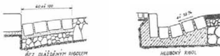
Obr. 109. Ukázka rigolku odvádějícího dešťovou vodu podél zvýšeného chodníku z poloviny 20. století.
