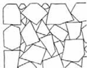
Obr. 17. Dlažba z nepravidelného ostrohranného kamene, skladba „na roh“.
