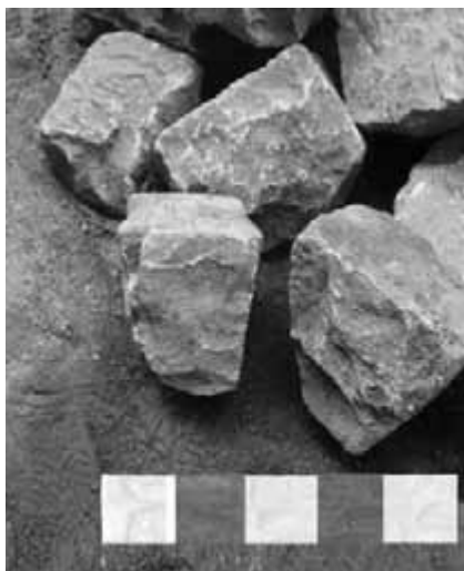
Obr. 28. Opracované křemencové kameny, takzvané kočičí hlavy. Některé z nich mají zašpičatělou spodní část. Byly dodávány pro pražské dlažby zhruba do roku 1820.
