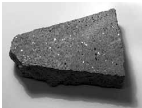
Obr. 71. Zachovat, případně citlivě opravit je třeba i autentické povrchové úpravy venkovních komunikací, které jsou součástí areálu památek moderní architektury. Úlomek cementového potěru s lesklými šupinkami slídy je bohužel jediným zbytkem efektní povrchové úpravy, jež nebyla při opravě chodníku lázeňské kolonády obnovena.
