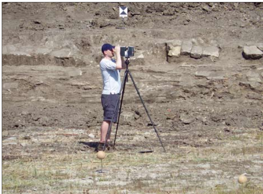
Obr. 22: 3D skenování opevnění břehů Pstružího rybníka. (Foto J. Janáč)
